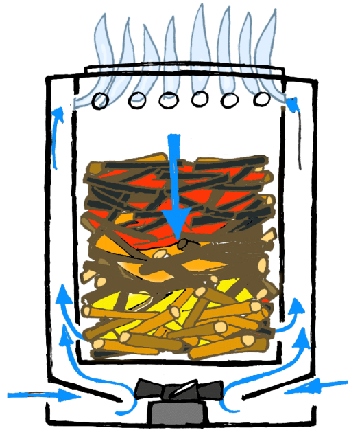
Schema funzionamento stufa a pirolisi con ventola
