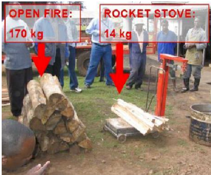
A sinistra consumo legna con sistema tradizionale (delle 3 pietre) e a destra consumo legna con stufa a pirolisi
