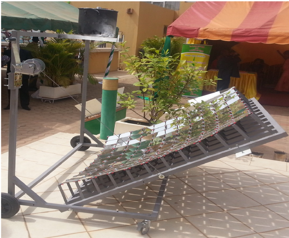
Cucina solare realizzata con specchi quadrati (modello Burkina)
