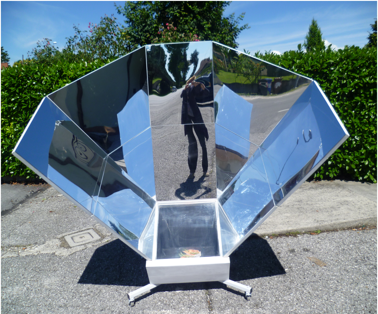
Forno solare grande (raggiunge i 280°)
