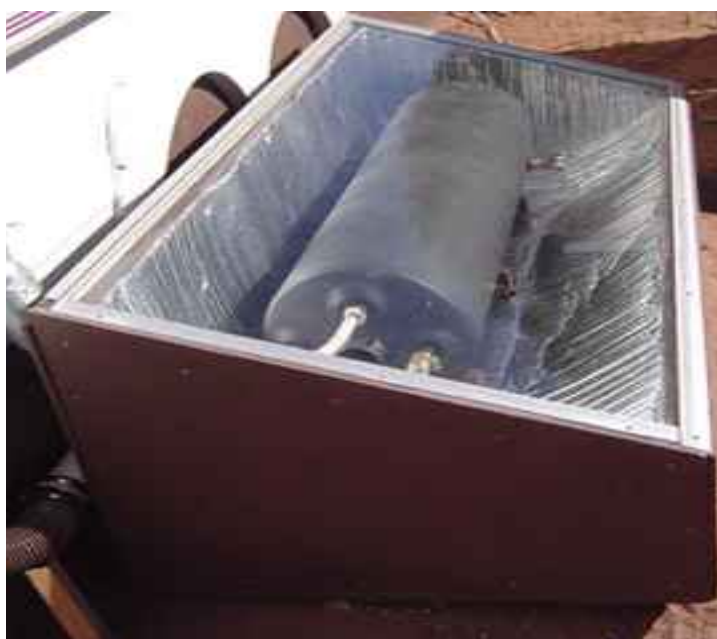
Scalda acqua con serbatoio da 200 litri
