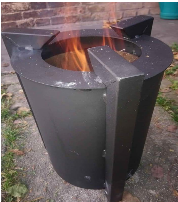
Stufa a pirolisi piccola per una pentola
