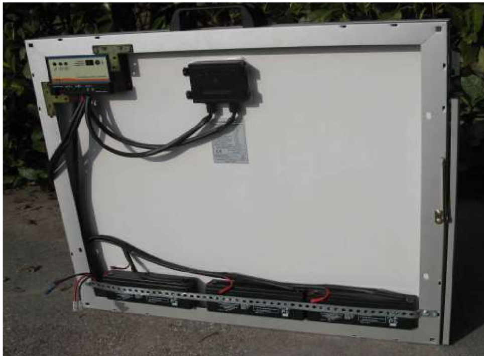
Valigia fotovoltaica da 100 Watt chiusa (lato batterie)
