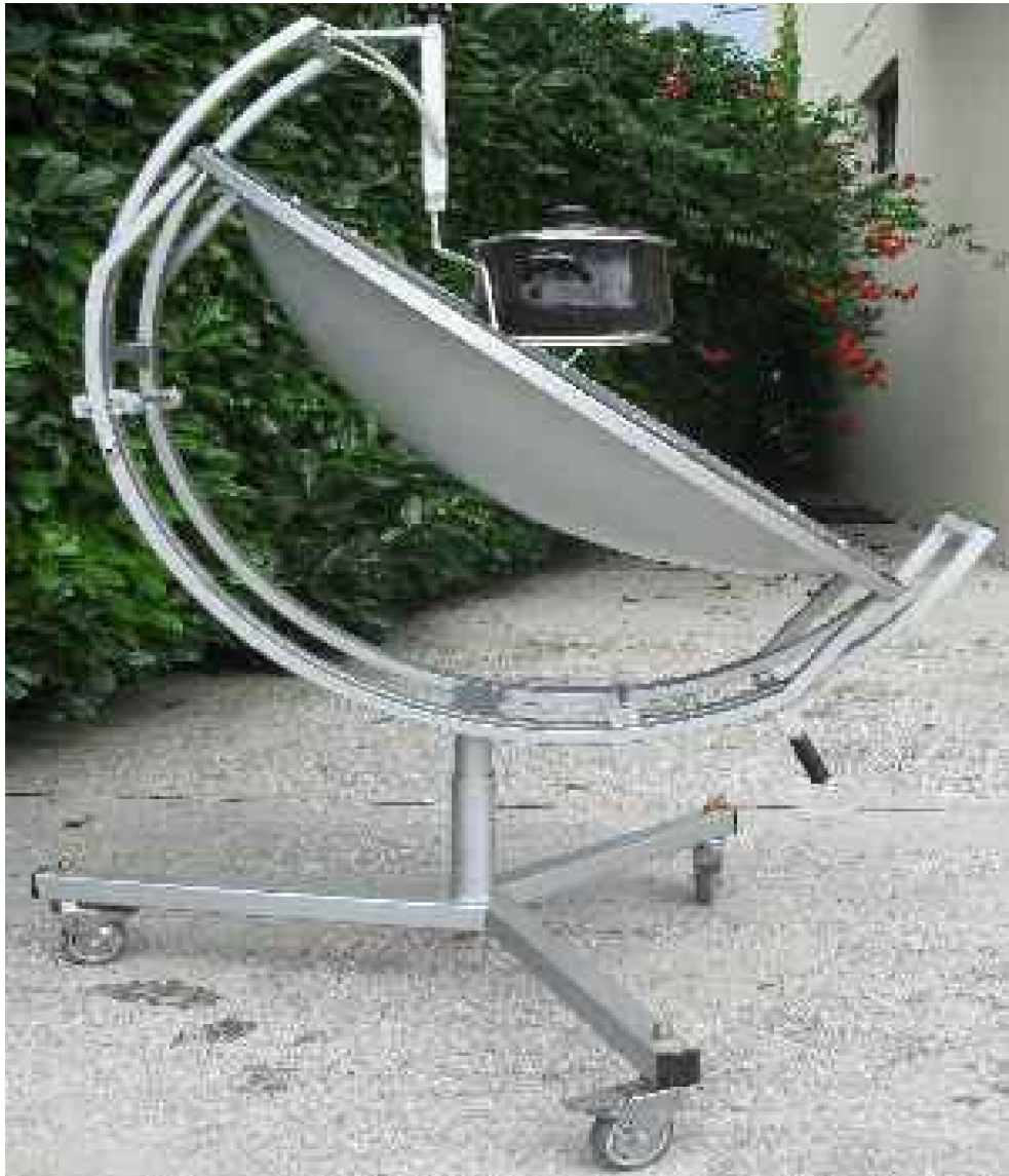
Cucina solare basculante con parabola in Plexiglas cromato
