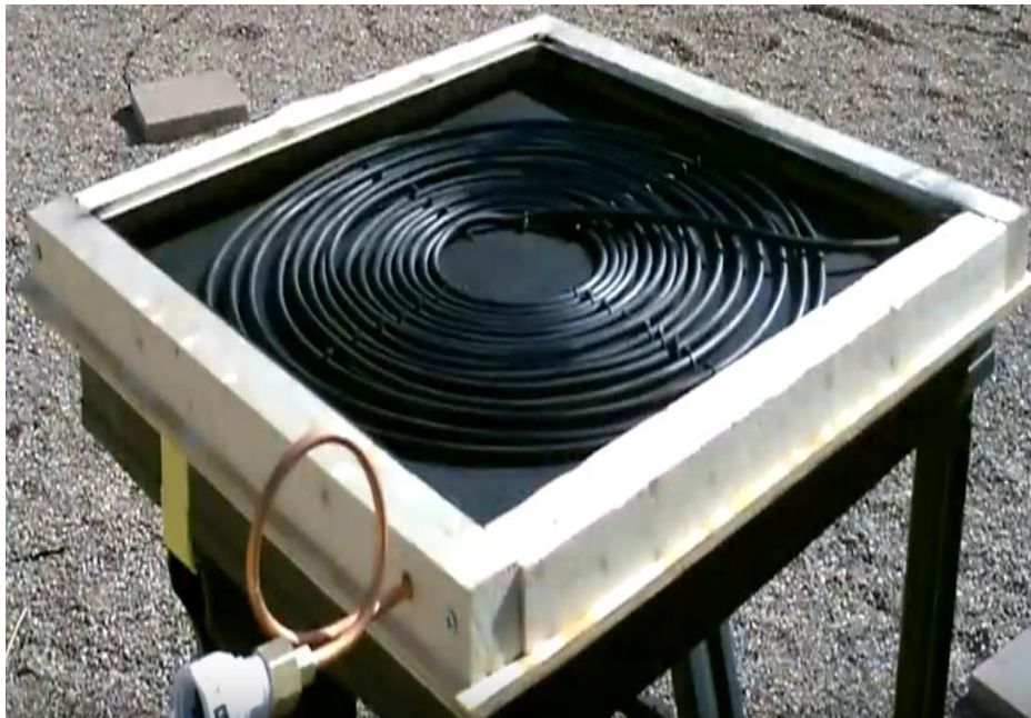
Pannello solare con telaio di legno e spirale di rame verniciata (va poi inserito un vetro in alto all'interno del telaio per creare l'effetto serra e impedire al caldo di uscire)
