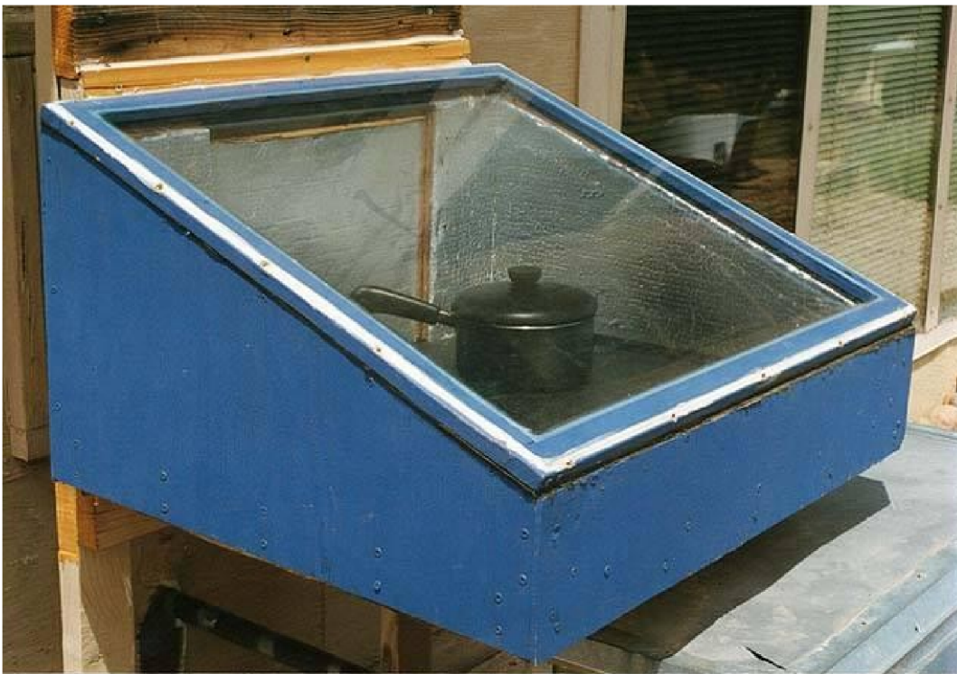
Forno solare installato nella parete a sud della casa
