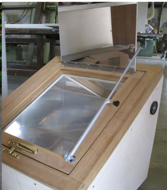
Forno solare piccolo (raggiunge i 130°) Particolare leva regolazione specchio
