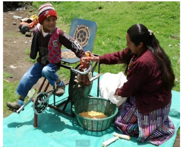
Mulino per mais in funzionamento
