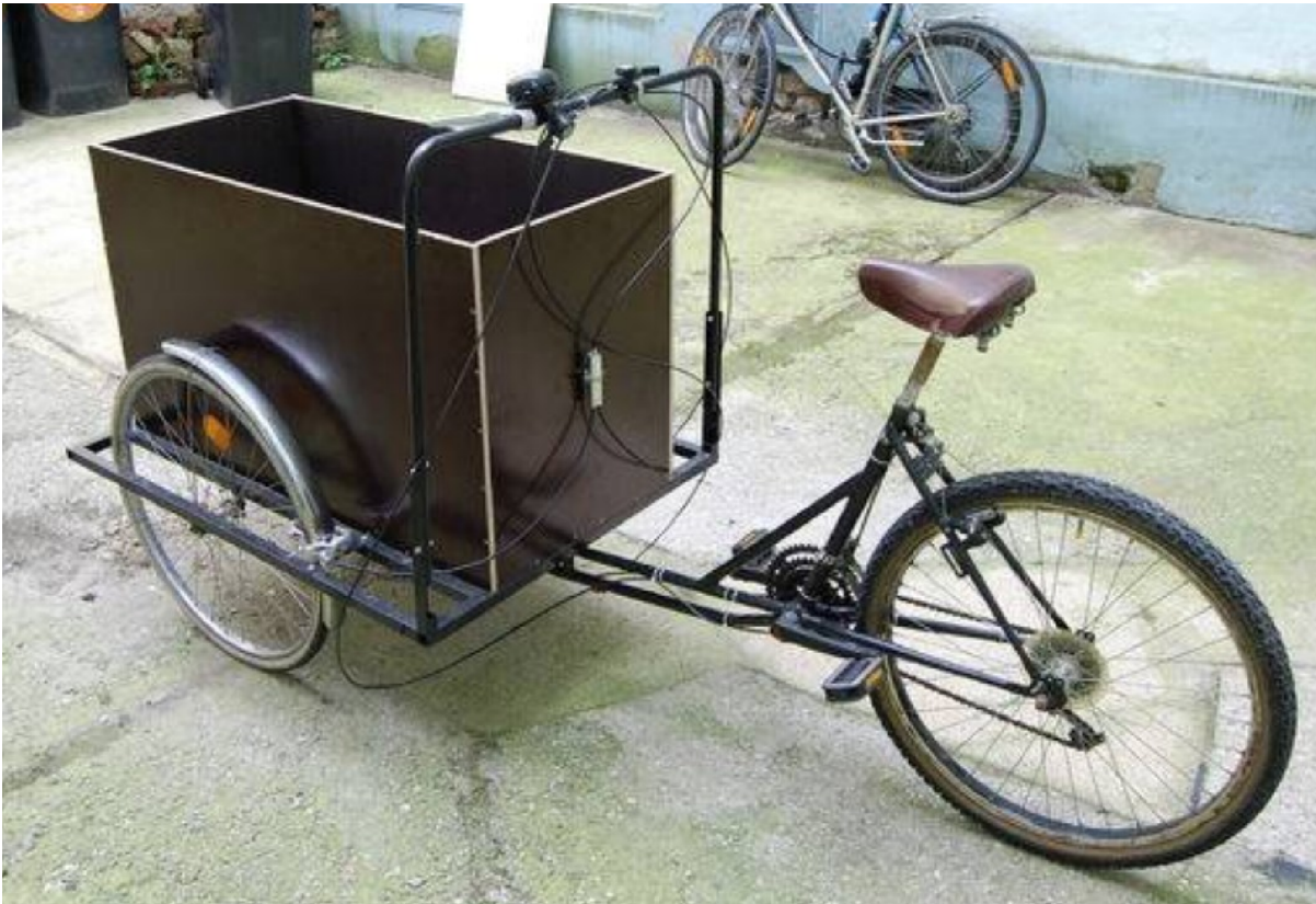
Modificando una bicicletta è possibile ottenere un veicolo con un cassone adatto al trasporto merci.
