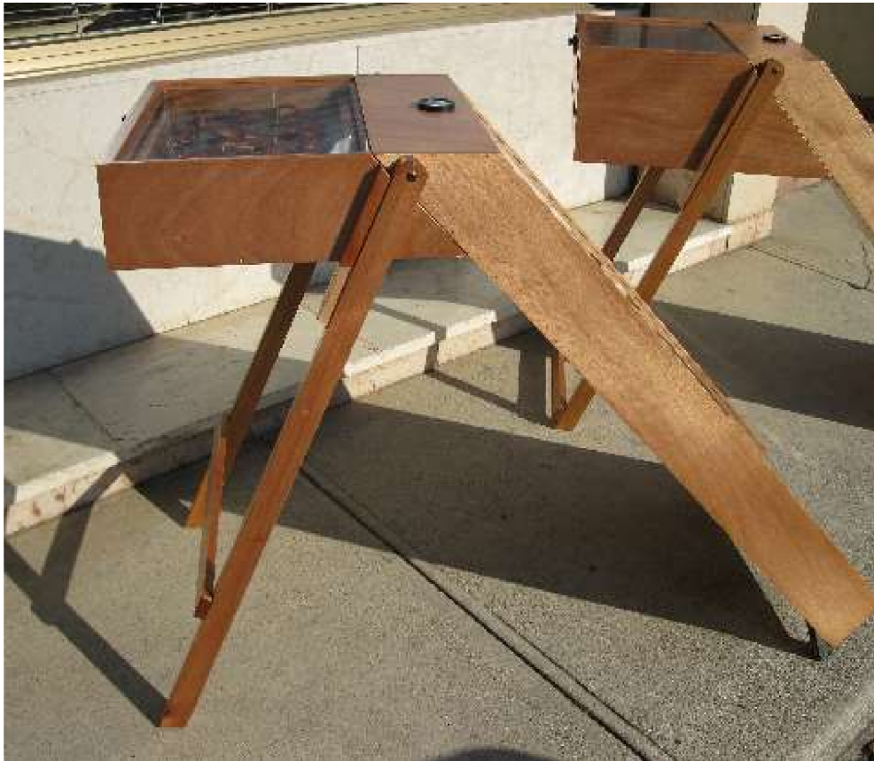
Essiccatore solare domestico pieghevole (a due ripiani)
