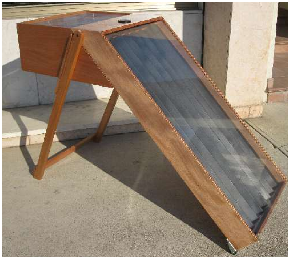
Essiccatore solare domestico pieghevole (a quattro ripiani)
